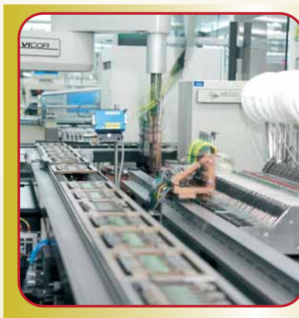
Bild 2. Zum Fertigungsprozess zählen die Montage der elektronischen Bauteile auf die Leiterplatte, automatische Zwischentests in der Produktion, Wellenbad-, Reflow- und Infrarot-Löten, Verguss der Wandler-Unterbaugruppen, Burn-In und Temperaturzyklen sowie der Endtest mithilfe automatischer Testsysteme
